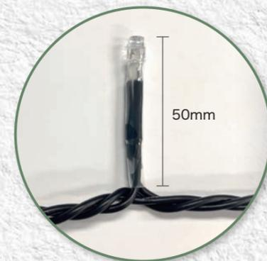
特にお客様の不安として多いのが「雨天時の漏電」。電気設備技術基準では0.1MΩ以上を安全基準とし、1MΩ以上で安心、5MΩ以上で漏電の心配がないとされております。調査の結果、LED部の収縮チューブが短いと漏電のリスクが高まることが判明。収縮チューブを延長し50mmとすることで、絶縁抵抗値を向上させることができました。さらに、撥水性の高い防水材と収縮チューブの最適な組み合わせも16通り検証。結果、1000MΩ以上を維持する高い安全性を実現しました。
