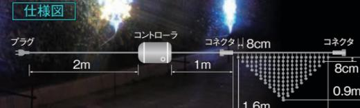
延長用...コントローラ付電源コードが付いていません。コントローラ付...本体・コネクタ・コントローラ付電源コードのセットです。
